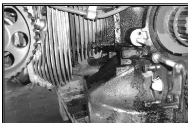
Perdita ai tubi di ritorno d'olio motore
